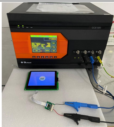
3.2 群脉冲测试图 EFT test
