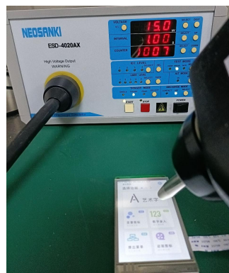
3.1 静电放电测试图 Electrostatic discharge test
