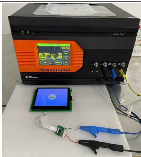
3.2 群脉冲测试图 EFT test
